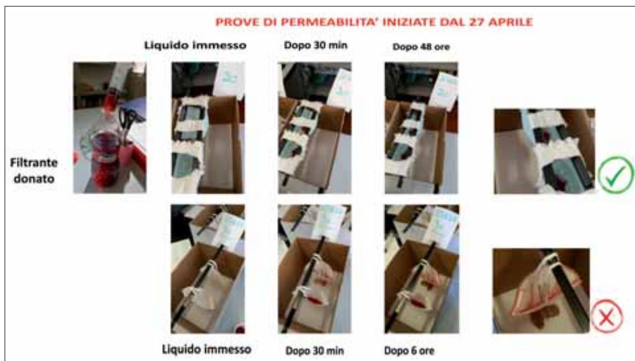
Figura 2. Prove di permeabilità di valutazione dei DPI per emergenza COVID-19
